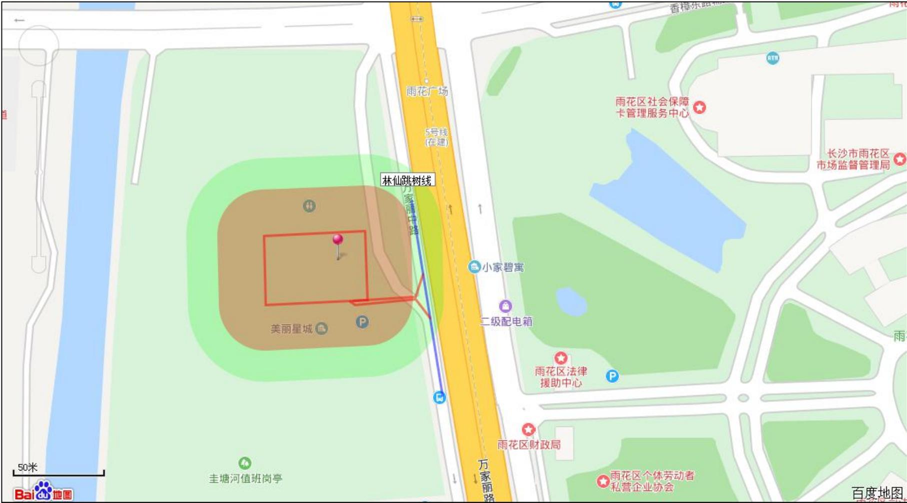
附图 3 林仙跳树线（湘府路 T 接点）改进林海变 110kV 线路工程线路路径图
